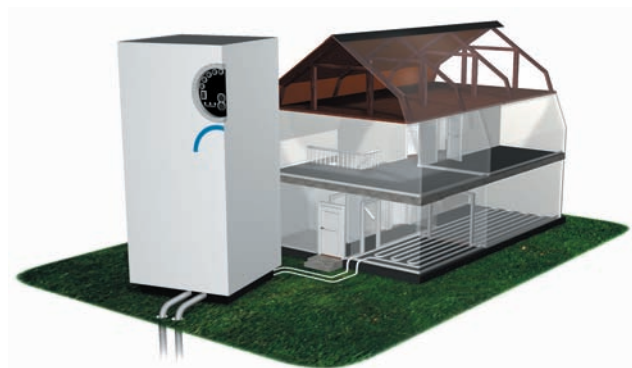
Gulvvarmesystem med varmepumpe.
