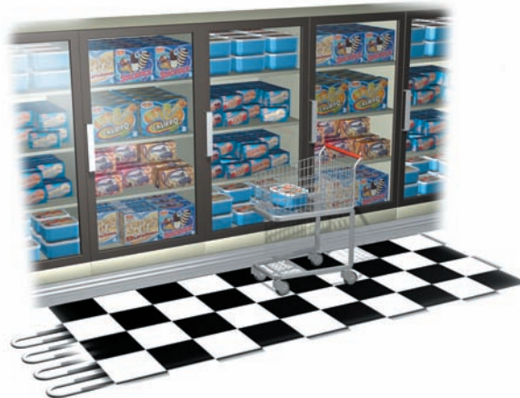
Gulvvarme med spildvarme fra køleanlæg.
